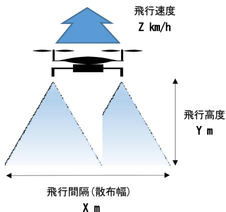
空中散布においては、散布方法（飛行速度、飛行高度、飛行間隔及び最大風速）の各要素が薬剤の拡散に影響を及ぼすため、均一散布及びドリフト抑制の観点では、全ての項目が明らかにされることが望ましい。
